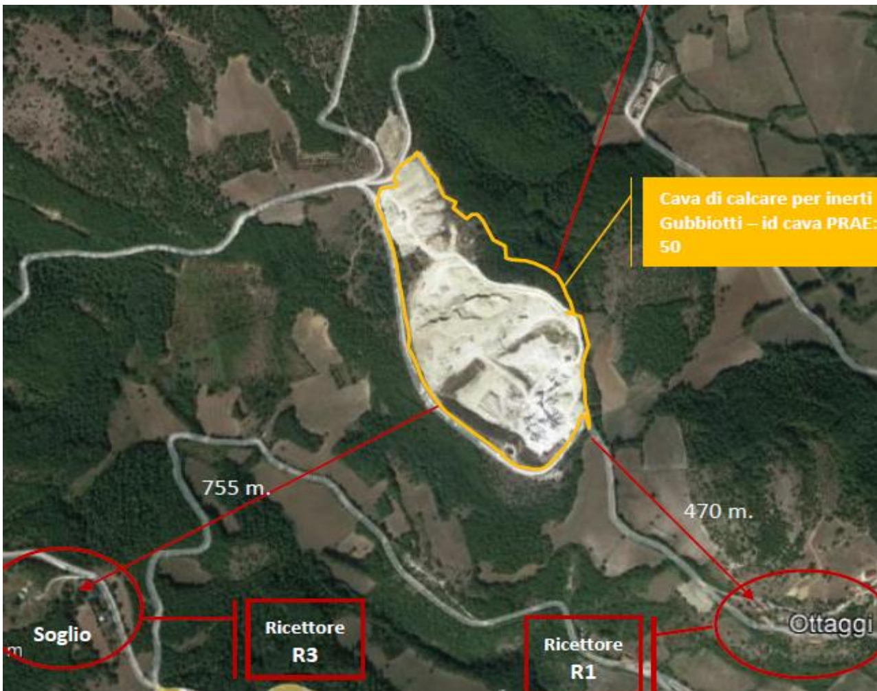
Fig.7: posizione del recettore R1 ritenuto significativo poiché maggiormente interessato da possibili fenomeni di disturbo sonoro, in relazione alla sua posizione rispetto alla zona di collocazione delle attività produttive in esame
