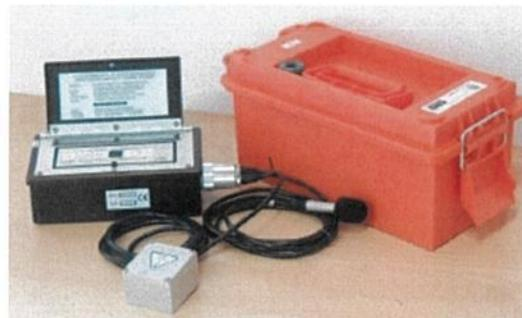
ACCESSO RS-232 per scaricare le registrazioni direttamente al pc oppure con collegamento remoto via modem o gsm. Microfono per la misura dell'onda di sovrappressione aerea e velocimetro triassiale per la misura delle vibrazioni.
