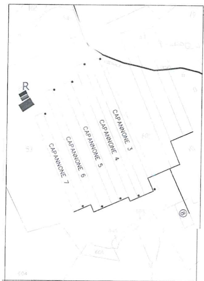
Sviluppo Planimetrico - Materie utilizzate e rifiuti - ● Silos ■ Area Stoccaggio Pollina ■ Cella frigorifera per galline morte R Area rifiuti
