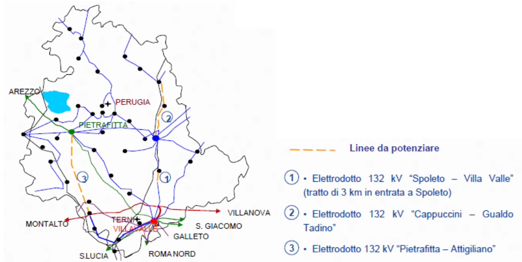
Figura 25: Potenziamento linee a 132 kV - TERN S.p.A.
